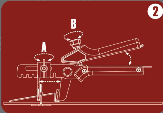
**Istruzioni:** Agire sulla vite a farfalla A per spostare il cursore nella corretta posizione in funzione dello spessore della piastrella. Perfezionare la regolazione agendo sul pomello B. Nota bene: la corretta regolazione è quella che permette di esercitare la massima spinta possibile sul cuneo senza però provocare la rottura della base. **Didascalie immagini:** Immagine 1: Prima della regolazione; Immagine 2: Dopo la regolazione.
