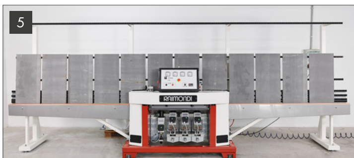
5 Ideale per l'esecuzione in serie di smussi a 45°: ad esempio su lastre 90x45 cm (fig.5) o listelli 15x100 cm (fig.6). Infinite possibilità Perfect for serial processing. Examples: pic.5 - 90x45 cm (35.5"x17.7") tiles; pic.6 - 100x15 cm (39.3"x5.9") strips. Endless possibilities
