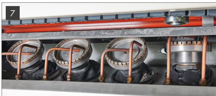
7 4 mole a tazza frontali (fig.7 e fig.8): la prima per la rettifica della costa, le altre 3 per l'esecuzione del jolly o del bisello. Regolazione micrometrica delle mole tramite manopola (fig.8b) 4 frontal cup-diamond-wheels (pic.7 and pic.8): the first for edge finishing, the others for 45° edge miter shaping and/or for beveling. Micrometric fine-adjustment of the wheels (pic.8b)
