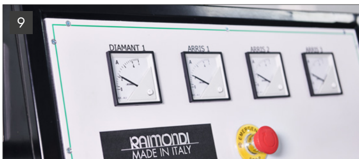
9 Fig.9 - Quadro comandi con indicazione assorbimento elettrico di ogni singolo motore (4 motori in totale) | Fig. 10 - Regolazione elettronica della velocità di avanzamento della piastrella/lastra Pic. 9 - Control panel shows electrical absorption of each individual motor (4 motors in total) | Fig. 10 - Electronic adjustment of the tile/slab feed speed
