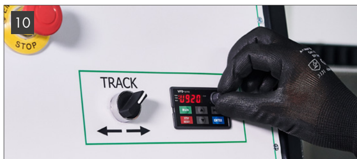
9 Fig.9 - Quadro comandi con indicazione assorbimento elettrico di ogni singolo motore (4 motori in totale) | Fig. 10 - Regolazione elettronica della velocità di avanzamento della piastrella/lastra Pic. 9 - Control panel shows electrical absorption of each individual motor (4 motors in total) | Fig. 10 - Electronic adjustment of the tile/slab feed speed
