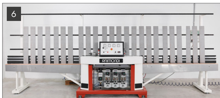
5 Ideale per l'esecuzione in serie di smussi a 45°: ad esempio su lastre 90x45 cm (fig.5) o listelli 15x100 cm (fig.6). Infinite possibilità Perfect for serial processing. Examples: pic.5 - 90x45 cm (35.5"x17.7") tiles; pic.6 - 100x15 cm (39.3"x5.9") strips. Endless possibilities
