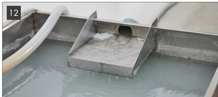
Fig. 11 - Regolazione cingoli di trascinamento in funzione dello spessore lastra: minimo 3 mm; massimo 20 mm | Fig. 12 - Vasca ricircolo acqua con sistema filtraggio e decantazione Pic. 11 - Fine adjustment of the dragging belts according to tile thickness: minimum 3 mm (0.12"); maximum 20 mm (0.79") | Pic. 12 - Water tank provided with filtering and settling system
